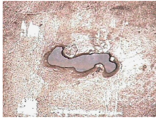
شکل ۲. به ترتیب از راست به چپ تصویر مربوط به خرابی حفره و خراش
