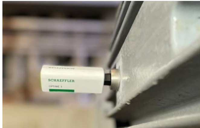
شکل ۶. سنسور Uptime3 نصب شده بر روی یک الکتروموتور [۸]
