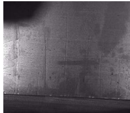
شکل ۱. به ترتیب از راست به چپ تصویر مربوط به خرابی چین های عرضی و زنگ زدگی.
